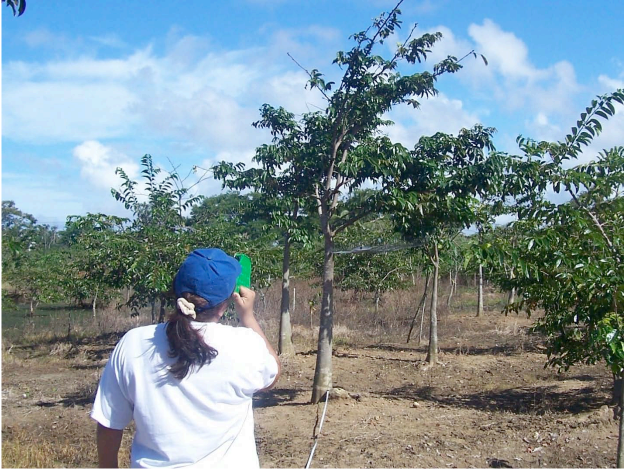
Medición de la altura con la regla tangente y cinta métrica Fotografía tomada el 29 de octubre de 2008-11-11
