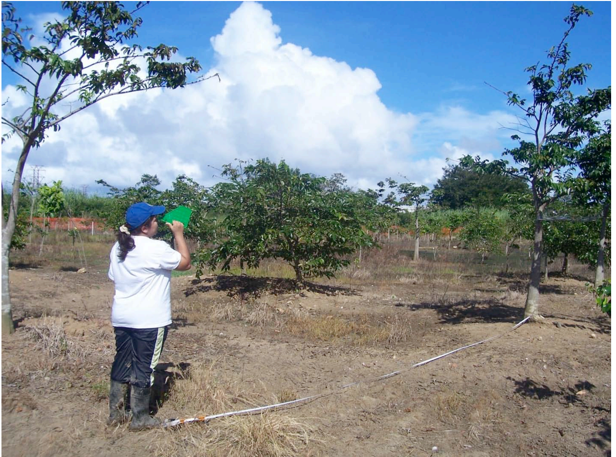
Medición de la altura usando la regla tangente y cinta métrica Fotografía tomada el 29 de octubre de 2008
