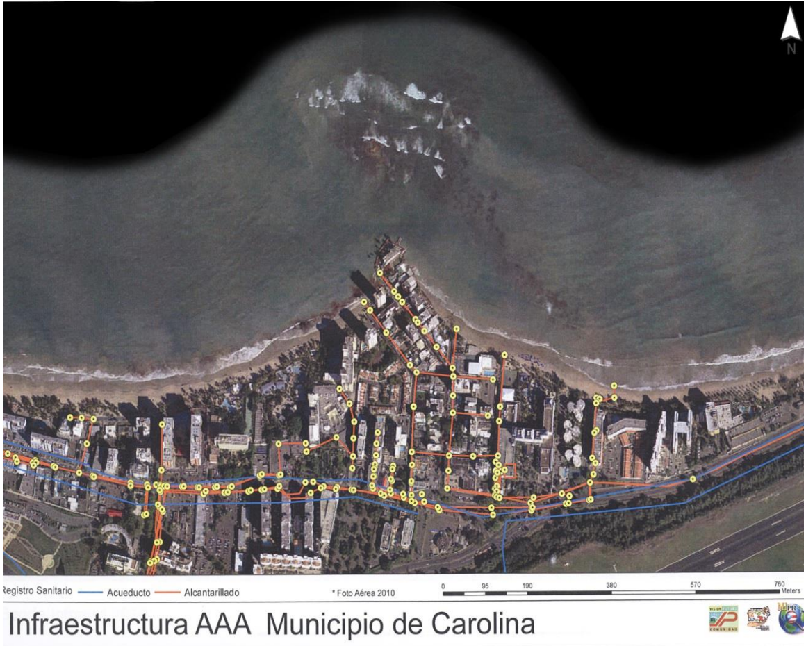
Figura 3. Alcantarillado de la zona del arrecife de Isla Verde.
