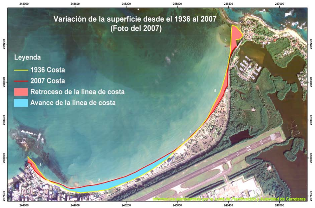
Figura 4. Fotografía aérea del año 2007 del litoral costero entre Punta El Medio y Boca de Cangrejos mostrando la variación de la superficie por tramos 1-6 del 1936-2007.
