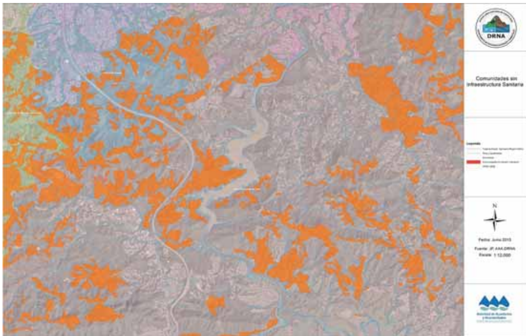
Figura 3. Comunidades sin alcantarillado sanitario (color anaranjado) alrededor del embalse Carraízo.
